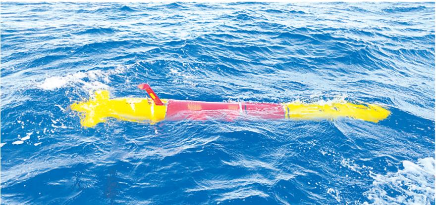
深海微生物宏基因组原位采样水下航行器进行海上试验。 受访单位供图
