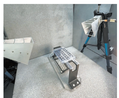
切纸技术为制造轻巧灵活的微波天线开辟了新途径。 图片来源:美国德雷塞尔大学
