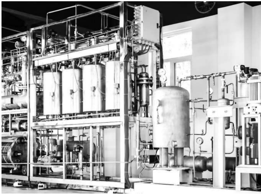
图为国创氢能（大连）新材料有限公司的电解水制氢设备。 受访单位供图
