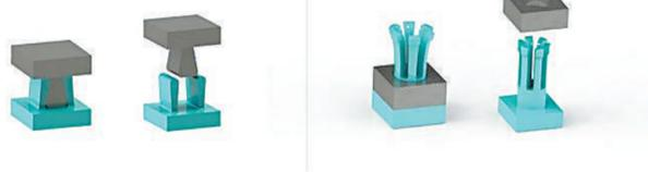
处于不同状态的两种互锁超表面结构。图片来源:美国得克萨斯农工大学
