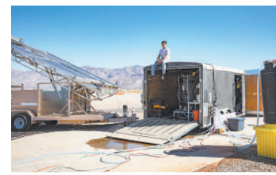
一位工程师坐在一辆拖车上，拖车里装有电渗析海水淡化系统。 图片来源：美国麻省理工学院
