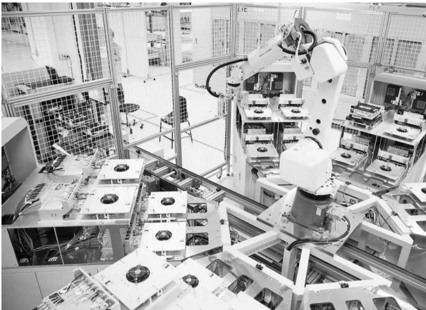
图为中兴通讯南京智能滨江5G工厂的5G小站测试线。
