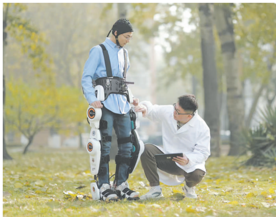
图为天津大学科研人员正在对脑机接口外骨骼机器人开展功能测试。受访者供图
