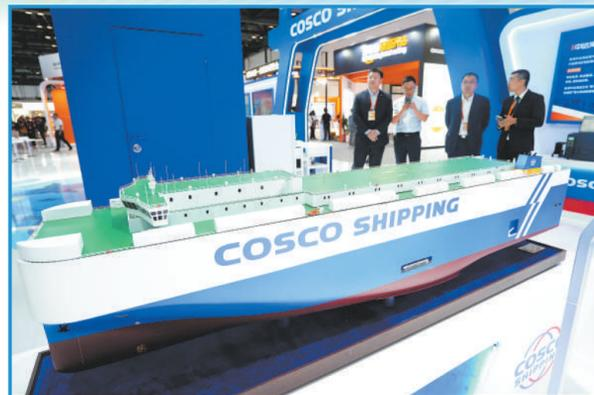
7500车位LNG双燃料汽车船模型
