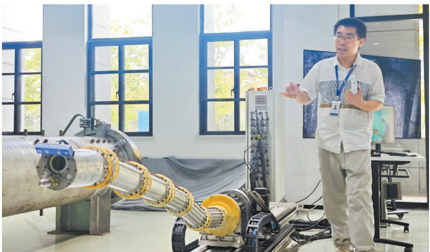
王程持操作手柄演示蛇形检测机器人。洪恒飞摄
