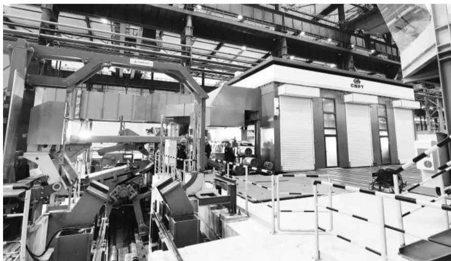
图为国产首台套“1+3”1850毫米铝带热轧连轧机组。
