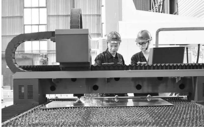
工人在生产车间通过电脑操控机械臂进行激光切割。 许传宝/视觉中国
