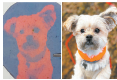
左图为悬浮在聚合物薄膜中的二维光雕刻图,右图为原始照片。
