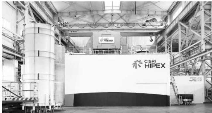
图为我国首台套超大型热等静压装备HIPEX1850。受访单位供图
