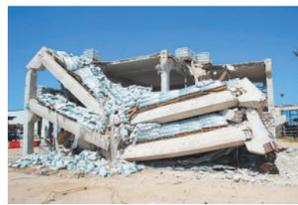
经测试全尺寸预制建筑只有部分结构发生坍塌。
