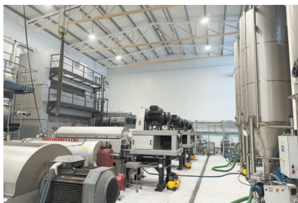
西班牙合作社的大型橄榄油厂。每年完成橄榄油压榨后,这些设备还会拆卸、改装为葡萄压榨生产线,以最大限度提升生产效率。 本报记者 李宏策摄
