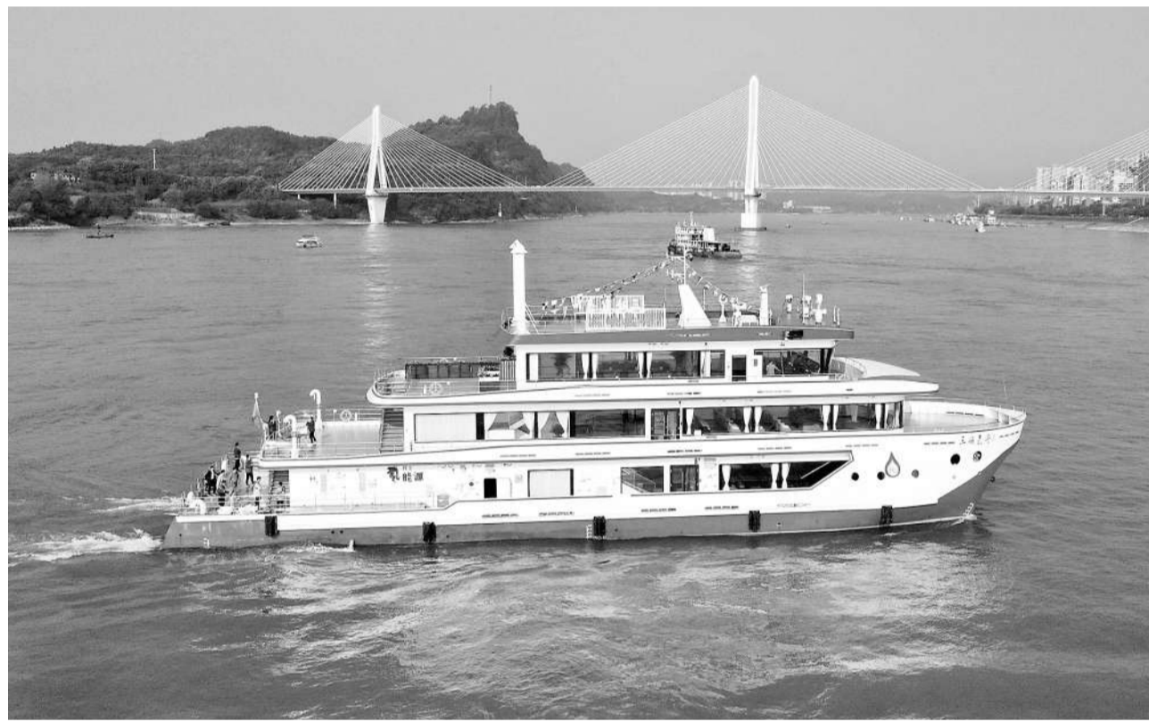
图为氢燃料电池动力示范船“三峡氢舟1”号首航。
