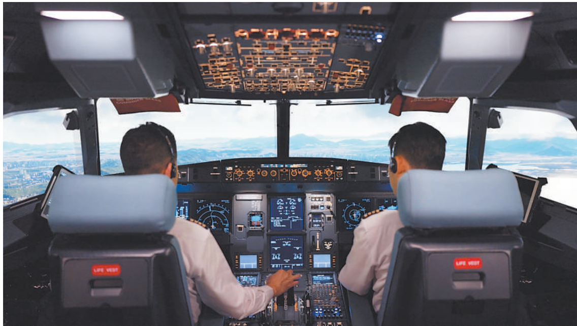
飞行员利用全动飞行模拟机视景系统进行训练。
