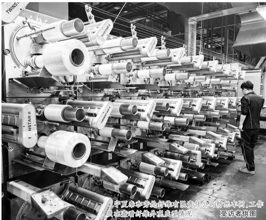
宁夏泰和芳纶纤维有限责任公司纺丝车间，工作人员正在查看纤维外观成型情况。受访者供图
