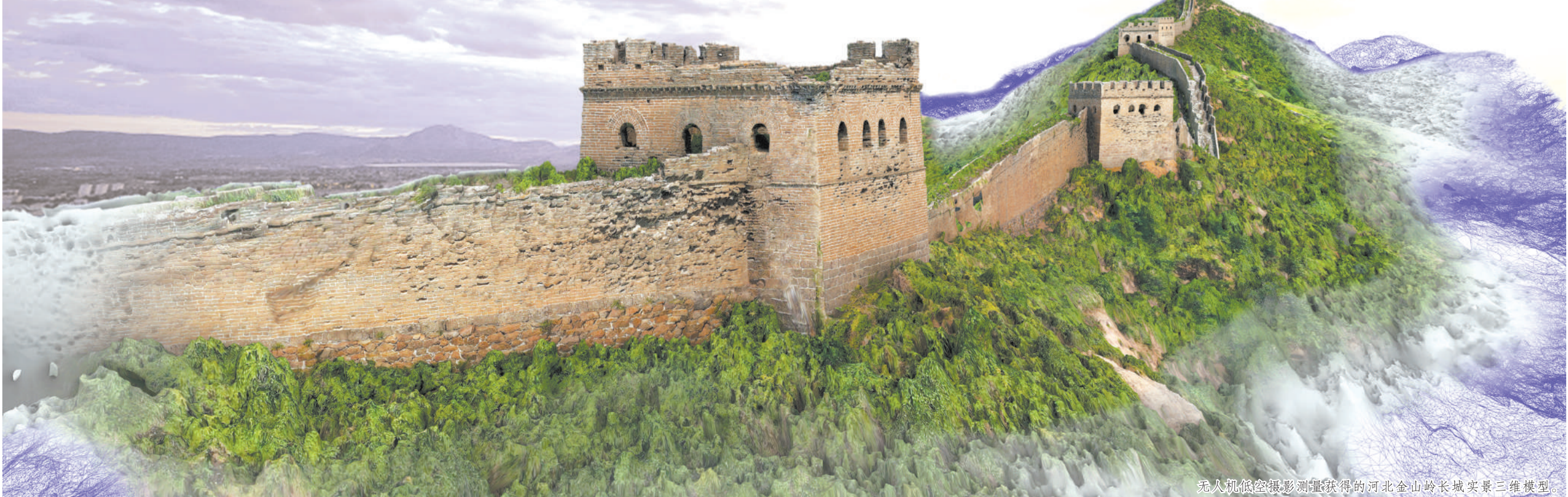
无人机低空摄影测量获得的河北金山岭长城实景三维模型。
