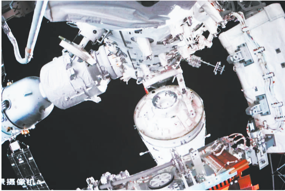
2022年9月30日在北京航天飞行控制中心拍摄的问天实验舱转位画面。这是问天实验舱与天和核心舱分离,采用平面转位方式进行转位。 新华社记者 郭中摄
