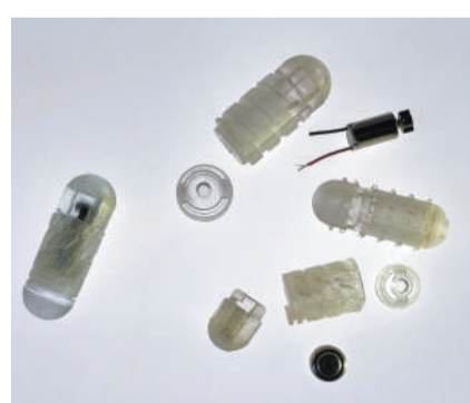
RoboCap胶囊有一个“机器人帽”,当它到达小肠时会旋转并穿过粘液屏障,让携带的药物进入肠道内的细胞。图片来源:麻省理工学院
