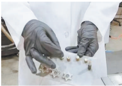
研究人员发现了一种利用火星尘埃进行3D打印工具和部件的方法。
