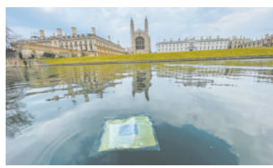
剑桥大学国王学院礼拜堂附近的卡姆河上漂浮的“人造树叶”利用阳光和水产生清洁能源。
