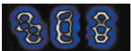
在扫描探针显微镜尖端施加电压脉冲,可以择性地、可逆地将中间的分子结构转变为右侧或左侧的结构。
