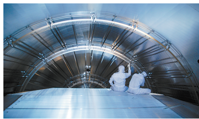
研究人员在KATRIN实验装置的主光谱仪中安装电极。 图片来源:约阿希姆·沃尔夫/德国卡尔斯鲁厄理工学院
