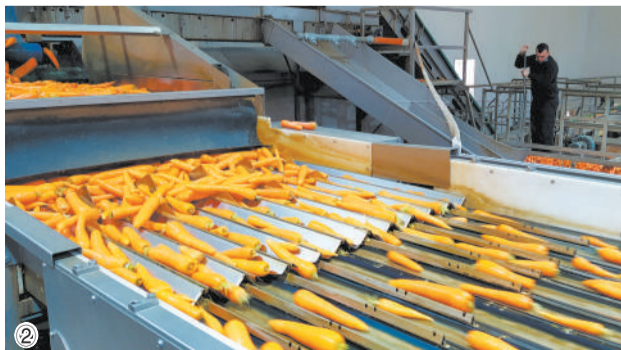
①胡萝卜上传送带准备进入清洗机 ②胡萝卜自动分拣系统
