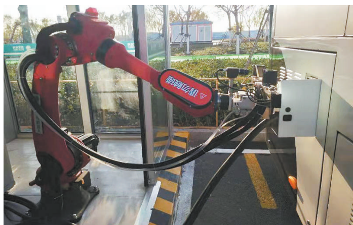
在中新友好图书馆公交站,充电机器人准确识别无人公交车停靠,自动完成插枪、充电、拔枪全过程。
