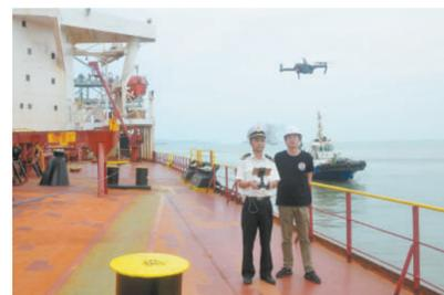
天津海关、杭州海关近日首次使用无人机辅助观测船舶水尺。无人机辅助水尺计量可以全程视频记录鉴定过程、有效还原工作现场,一旦发生货物短重情况可为国内企业索赔提供有力支撑,对船方也有一定的约束作用。同时,可降低企业的经济成本,提高通关效率,可谓一举三得。图为杭州海关关员操作无人机准备开展水尺丈量。
