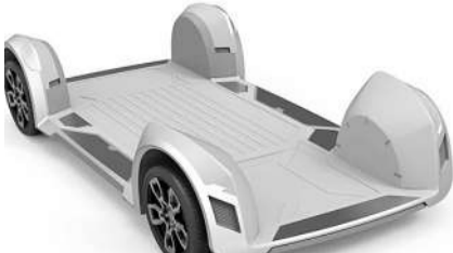
基于新车轮的平板模块化汽车底盘(示意图)。 图片来自REE公司
