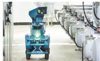
日前,GIS智能巡检机器人、悬挂轨道式机器人智能巡检系统、智能安防等多种类、全时段的智能防控巡检系统在国家电网北京新机场东、西110千伏变电站启用,形成“巡检、告警、检修、归档”的高效全面智能新巡检模式。图为1月12日,北京新机场西110千伏变电站内的GIS智能巡检机器人在巡检变电设备。
