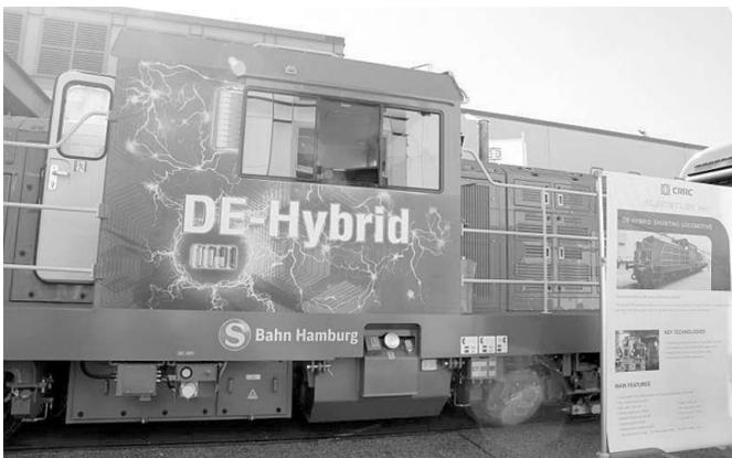
由中车株机公司为德国联邦铁路公司定制的一辆“内燃+蓄电池”混合动力调车机车,日前已交付德国汉堡车辆段。
