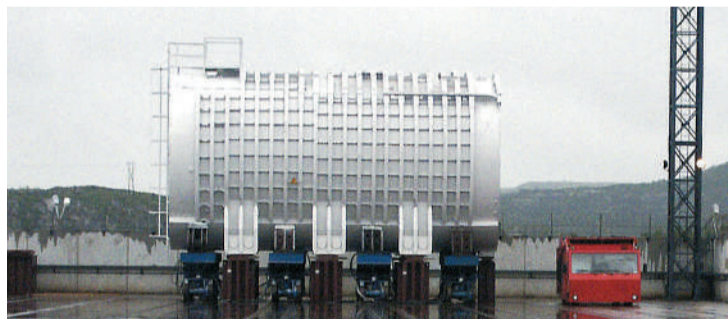
俄罗斯北方舰队退役核潜艇的核反应堆间隔设备。
