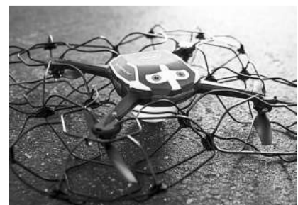
射星无人机的四个螺旋桨都有外壳保护 图片来源自网络
