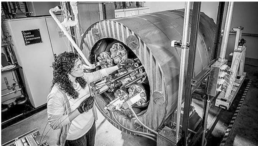
在NASA格伦极限环境装置(GEER)中进行高温高压测试的计算机芯片,有望帮助制造长寿命的金星着陆器。
