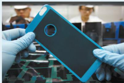
技术人员在生产电子产品的石墨烯贴膜，其可以有效降低电子产品工作时的温度，延长产品寿命；同时全新纳米固态表面涂层技术可以有效屏蔽97%的电磁波辐射。
