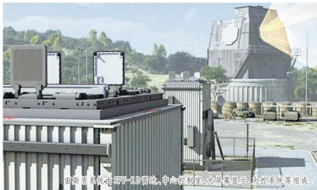
宙斯盾系统由SPY-1D雷达、中心控制室、大屏幕显示、火控系统等组成。
