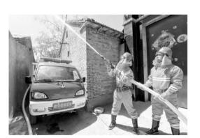
河北景县远大集团研制的消防巡逻车长4米,宽1.5米, 高1.9米,车内配有干粉灭火器、消防水带、消防斧等消防救 援器材,纯电动驱动。消防巡逻车的水枪可喷射75米的高 度,喷射半径达到100米。
