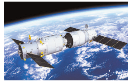
天舟一号与天宫二号交会对接组合体示意图。(中国航天科技集团公司供图)
