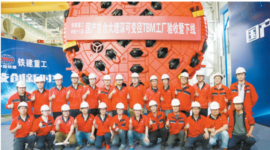
2016年5月5日,中国铁建重工集团研制的国产首台“大埋深、可变频”敞开式硬岩隧道掘进机(TBM)成功下线。这台TBM开挖直径6.53米,能在距离地面2000米以下的深处作业,且可根据工程需要调整开挖直径,有力推动了隧道掘进装备产业升级,提升了我国装备制造业水平和重大装备核心竞争力。
