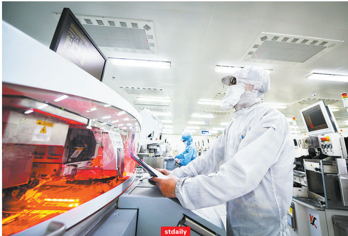
江苏江阴长电科技封装车间装片区域,作业员在操作装片机台进行作业。
