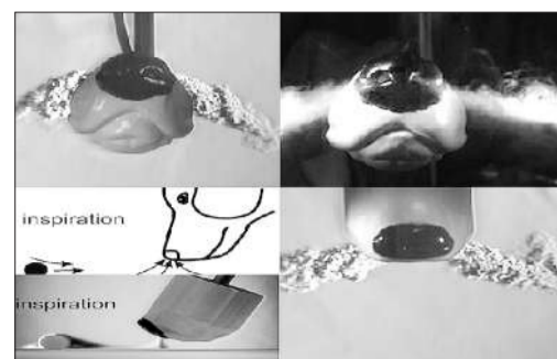
用3D打印制造的狗鼻子模型进行嗅闻的空气动力学分析。
