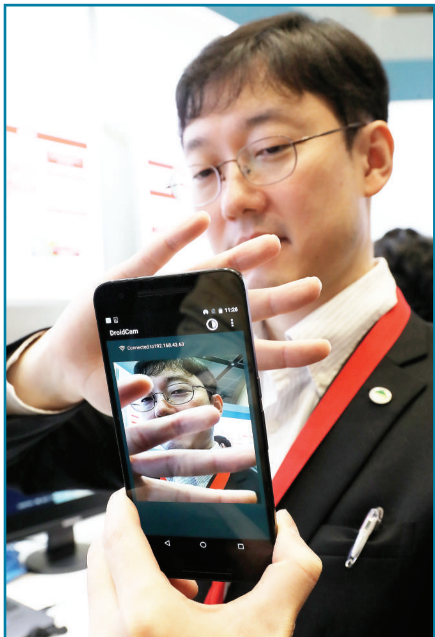
日立制作所发布了其研发的新技术——可进行手指静脉认证的智能手机照相机。该技术可以用指纹认证的方法判断使用者是否为本人。
