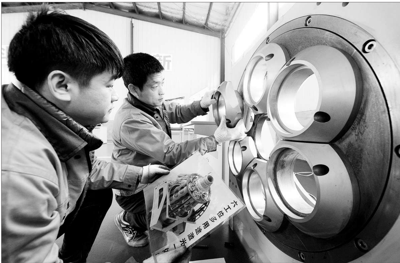
近日,廊坊文安顺顺三维科技有限公司与中国钢铁研究总院共同研发FMS-ZS-6 3D激光一体打印机,明年年初有望生产出国内第一台六工位3D打印设备样机。图为企业技术人员正在组装六工位3D打印设备。
