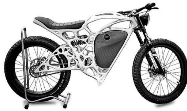
首辆完全3D打印的摩托车
