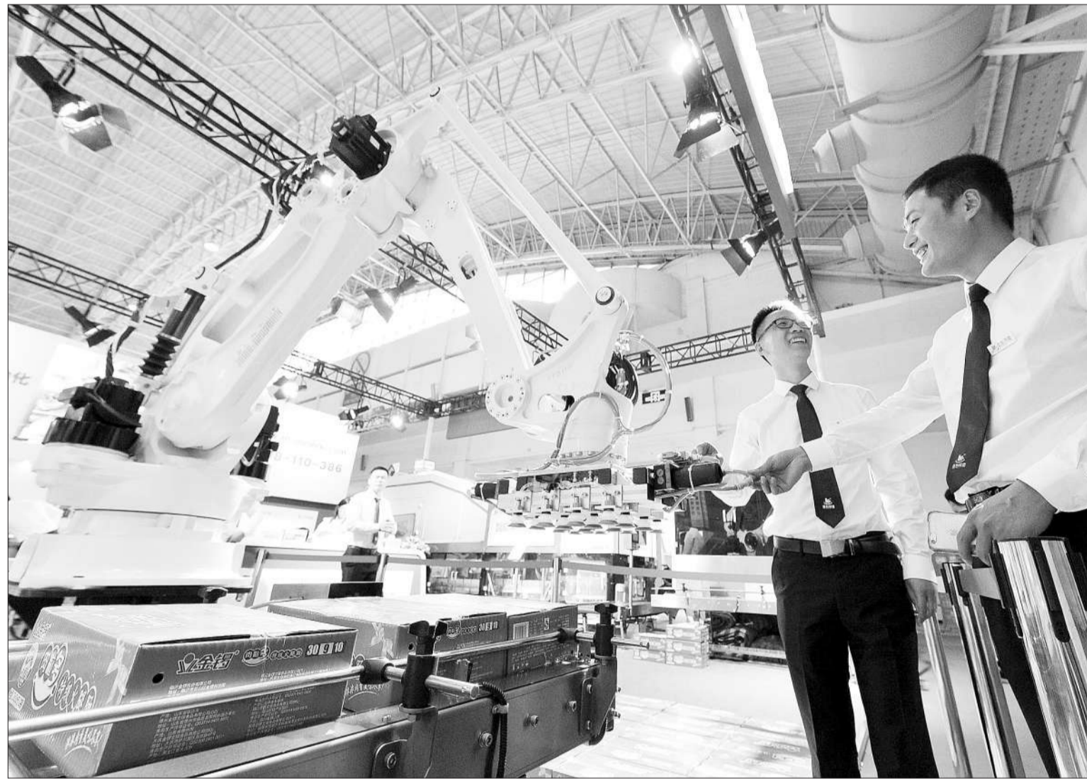
9月27日，2016第十四届中国国际肉类工业展览会在北京中国国际展览中心举行。国内外上百家知名参展商展示了肉类加工领域的最新产品和技术。图为参展商展示的机器人码垛系统。该系统最大机型可承载800公斤，最高码垛速度可达每分钟40箱以上。 本报记者 洪星摄
