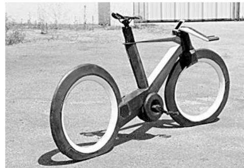
THE CYCLOTRON BIKE 是一辆有着独特造型的自行车,没有辐条与车轴,轮胎上装有LED,颇有未来自行车的风范。碳纤维轻质框架内装有齿轮、刹车、变速模块等各种零部件,0.2秒即可变速,车轮中间的“空洞”部分更可安装收纳等组件,还可发出激光线,夜晚骑行在路上相当拉风。
