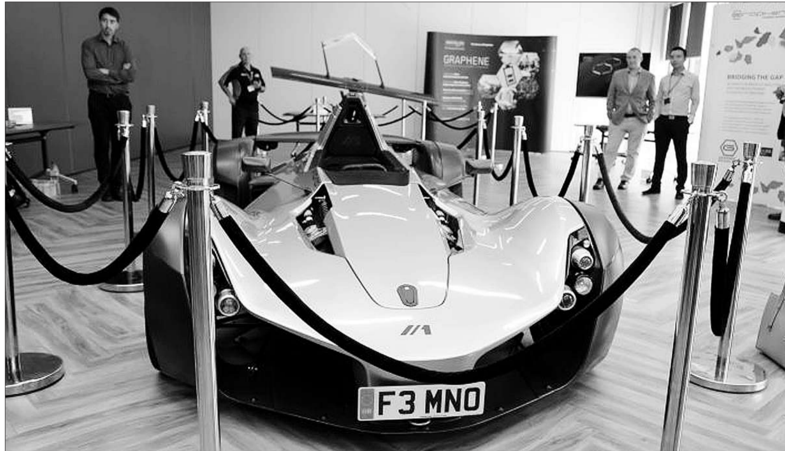
在第七届“欧洲科学开放论坛”举办期间,一款由英国制造商BAC公司推出的单座跑车原型BAC Mono在英国国家石墨烯研究院(NGI)展出。据NGI商业总监詹姆斯·贝克介绍,该车的后前板和舱口采用石墨烯复合材料制成,从而使得跑车整体更轻、更坚固。本报驻英国记者 郑焯斌摄
