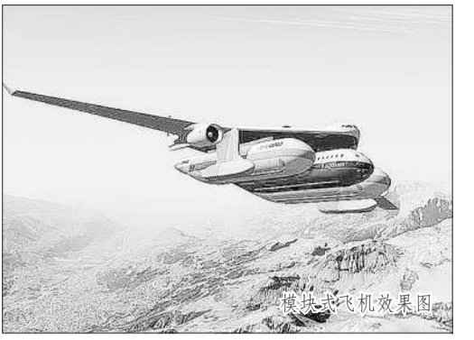
观察人士塞巴斯蒂安·莫达克认为,这一设计是围绕着一个永恒的理念:模块化。Clip-Air正在实验利用替代能源,如生物燃料和液态氢燃料,但即使它还是用化石燃料,Clip-Air的碳足迹也会更少,一次带3个吊舱飞行,载客量相当于3架波音737。
