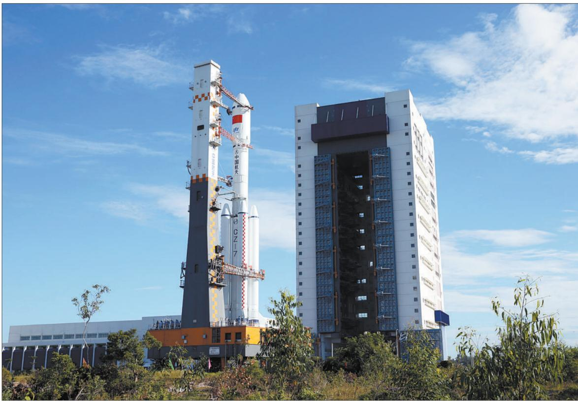
6月22日,执行海南文昌发射场首飞任务的长征七号火箭垂直转运至发射区。图为火箭从垂直测试厂房内缓缓推出。
