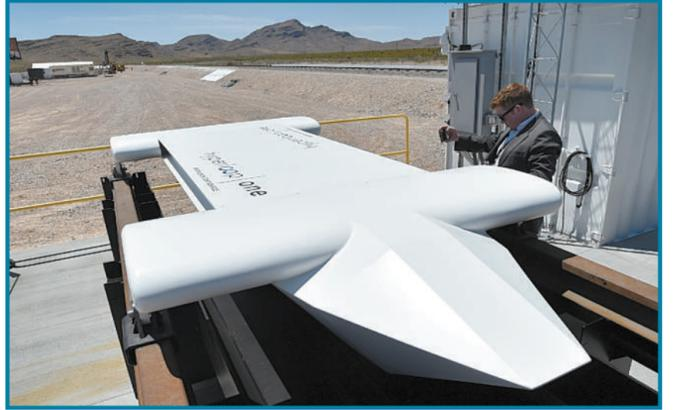
美国创业公司Hyperloop One的超级高铁推进系统首次户外测试成功,3米长的实验“滑车”在铺设好的轨道上运行了2秒钟,最终速度达到400英里每小时,撞击到91米外的沙堆减速停车。
