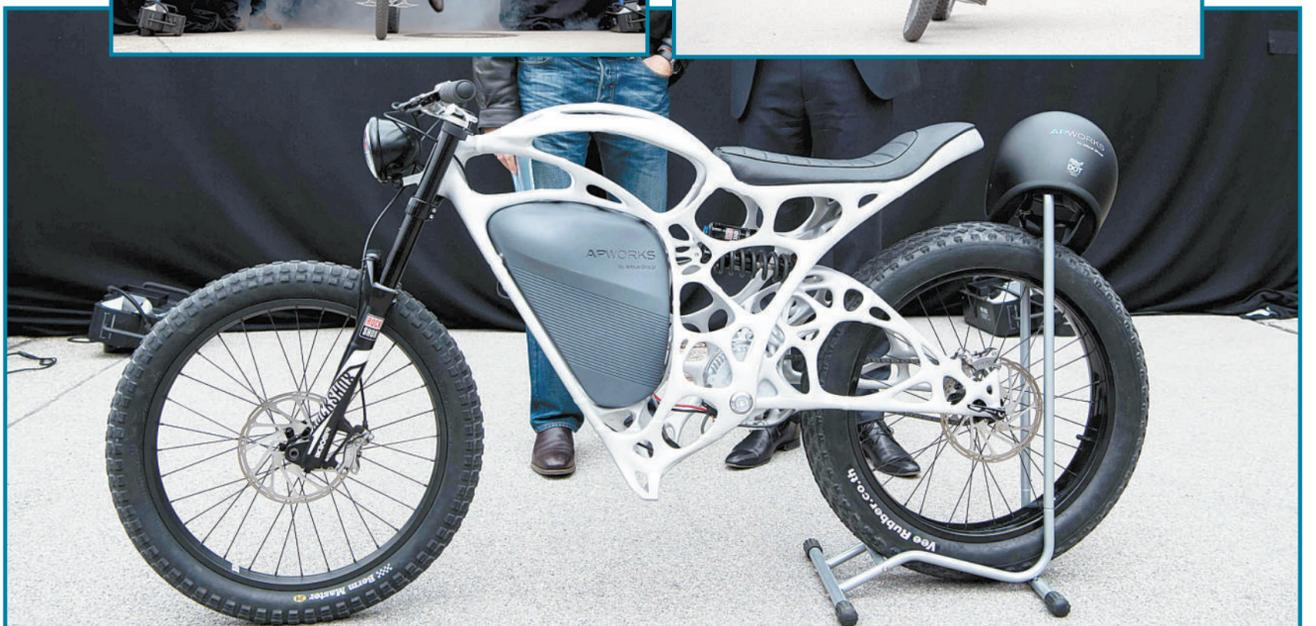
德国奥托布伦,一直以来都在十分积极探索3D打印技术的空中客车集团披露了其最新作品——世界上首辆全3D打印仿生电动摩托车LightRider。
